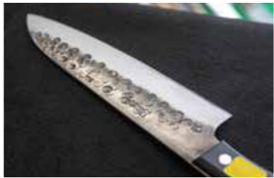
酸化鉄の粉末などを使い地金に鋼を接着させます(左)/常に温度管理しながら鍛造します(右上)/あえて錆の跡を生かした肌も、打刃物ならではの味わい(右下)
