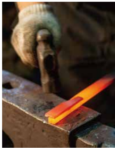
酸化鉄の粉末などを使い地金に鋼を接着させます(左)/常に温度管理しながら鍛造します(右上)/あえて錆の跡を生かした肌も、打刃物ならではの味わい(右下)
